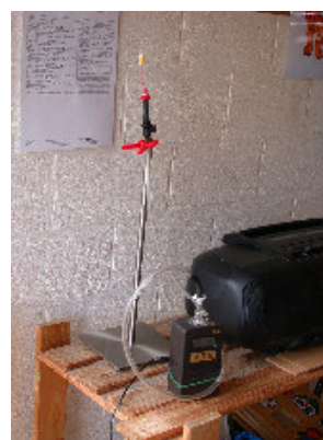
Photo 3 : Prélèvement d'air sur cartouche de DNPH
