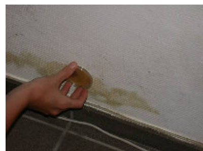
Photo 5 : Prélèvement à l'aide de boîte de contact
