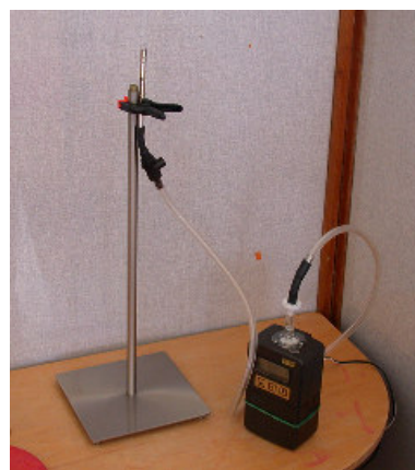
Photo 2 : Prélèvement d'air sur cartouche de Carbotrap
